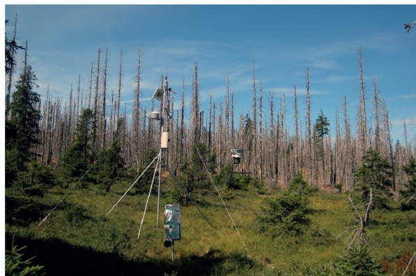
Obr. 4 Sněhoměrný polštář Plechý C7PLCH01, nadmořská výška 1 344m n. m.
