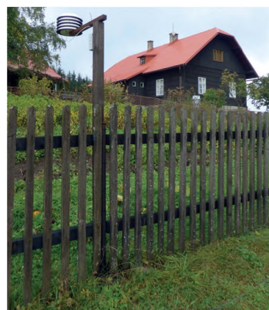
Obr. 1 Příklad instalace teplotního čidla Termio (lokalita Staré Hamry, Gruň, 22. září 2017, foto: Pavel Lipina).
