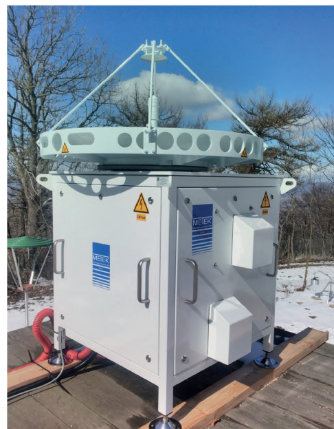
Obr. 1 Oblačný radar METEK Mira 35c na Milešovce.
