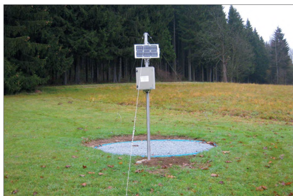
Obr. 2 Sněhoměrný polštář Staré Hutě C4STHU01, nadmořská výška 780 m n. m.
