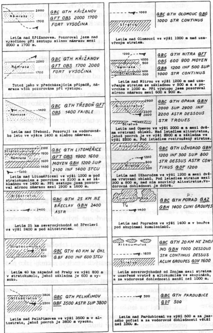
Obr. 1 Příklady meteorologického hlášení z letadla. Převzato z [7]. Fig. 1. Examples of meteorological reports from aircraft. Taken over from [7].
