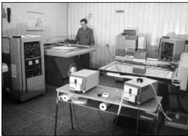
Obr. 8 Pracoviště automatického zákresu meteorologických materiálů u HPÚ z roku 1973. Je vybaveno počítači ADT 4300 a kreslicími stroji DIGIGRAF. Systém byl zaveden do provozu v roce 1973 a průběžně modernizován.
