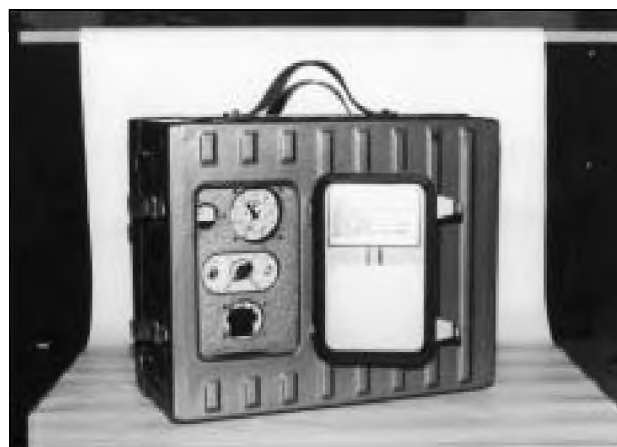
Obr. 6 Přenosná meteorologická stanice PMK (měřící čidla pro teplotu, tlak a vlhkost vzduchu, směr a rychlost větru). Touto stanicí jsou rovněž vybaveny jednotky pozemního vojska AČR.
