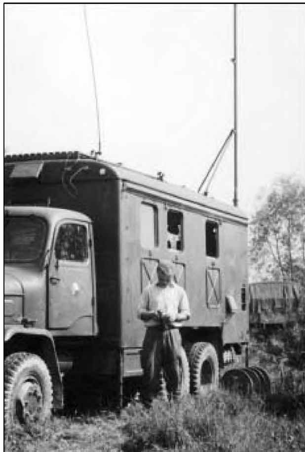
Obr. 2 V polních podmínkách rozvinutá mobilní povětrnostní stanice LPS-65 počátkem sedmdesátých let. Obdobně byla řešena zástavba radiosondážní stanice pro letectvo, PVO a RVD.
