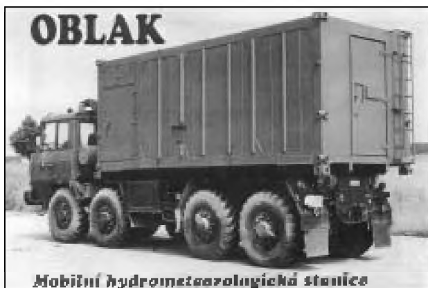
Obr. 10 Mobilní hydrometeorologická stanice OBLAK bez nosiče. Stanice je určena k provádění a podpoře hydrometeorologického zabezpečení druhů vojsk AČR. Kromě měření a pozorování, distribuce a příjmu dat z centrály zabezpečuje součinnostní výměnu informací s armádami členských států NATO.
