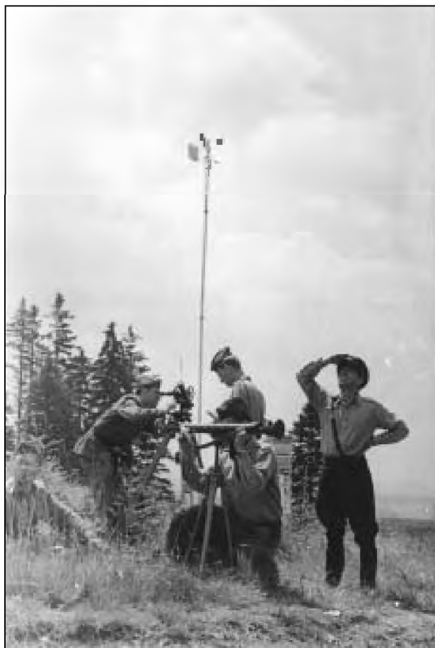
Obr. 1 V polních podmínkách rozvinutá meteorologická stanice. V jejím vybavení anemorumbometr ARME-1, pilotovací teodolit Sprenger, dělostřelecký dálkoměr a meteorologická budka, rok 1957.
