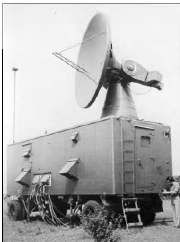
Obr. 4 Mobilní meteorologický radiolokátor MRL-1, rok 1983.
