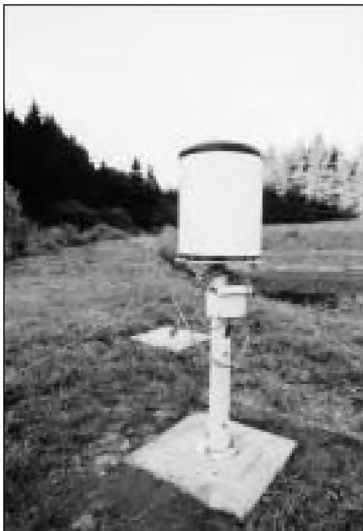
Obr. 5 Automatický výsuvný srážkoměr na Číhalce v Olešnici v Orlických horách.
