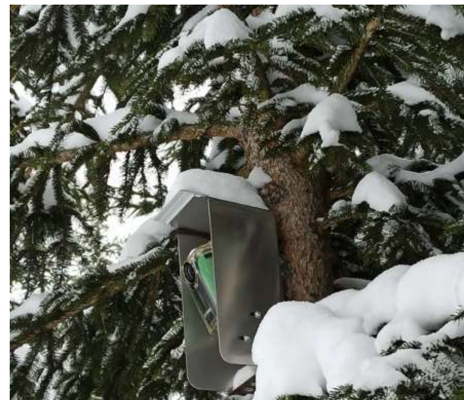
Zvýrazněné sněhotyče před minikamerou Kalibrační a expediční měření výšky sněhu a vodní hodnoty
