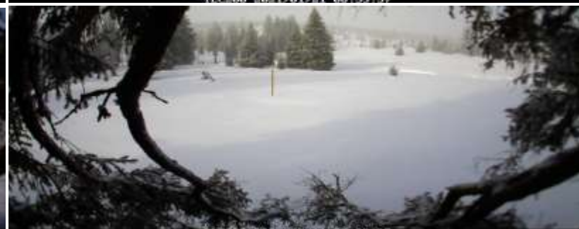
Zvýrazněné sněhotyče před minikamerou Kalibrační a expediční měření výšky sněhu a vodní hodnoty
