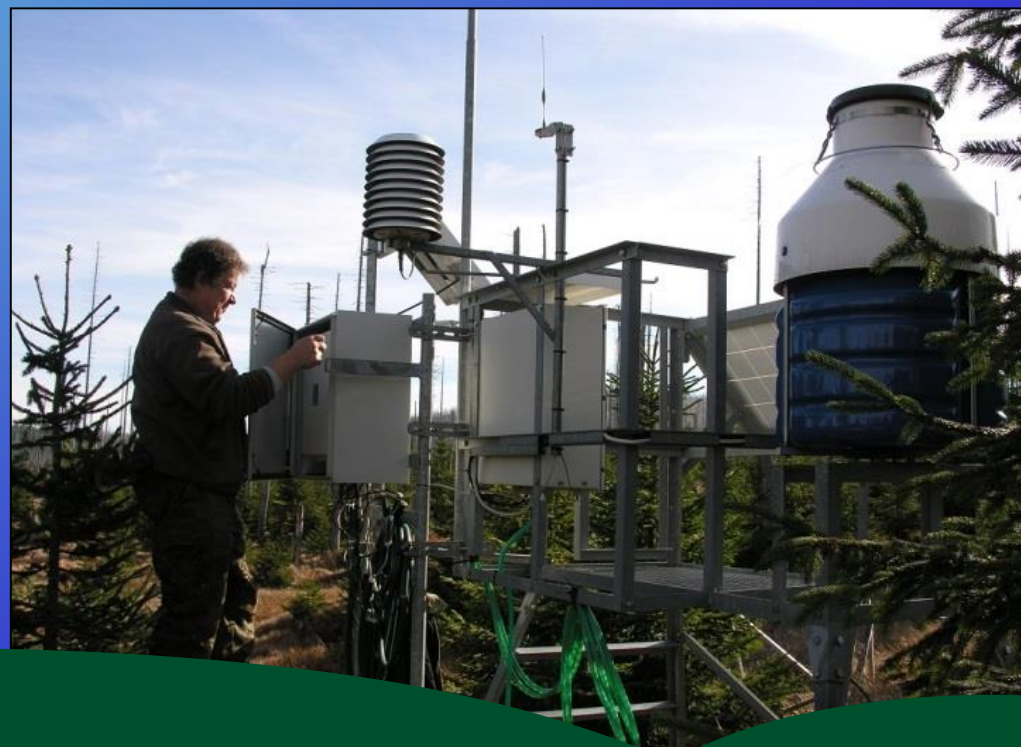
Poledník – meteorologická stanice a pasivní mlhoměr
