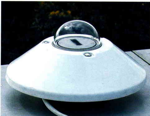
Obr. 6. Slunoměr SD4 se stínícím krytem. Fig. 6. The sunshine recorder SD4 with the sunshade.
