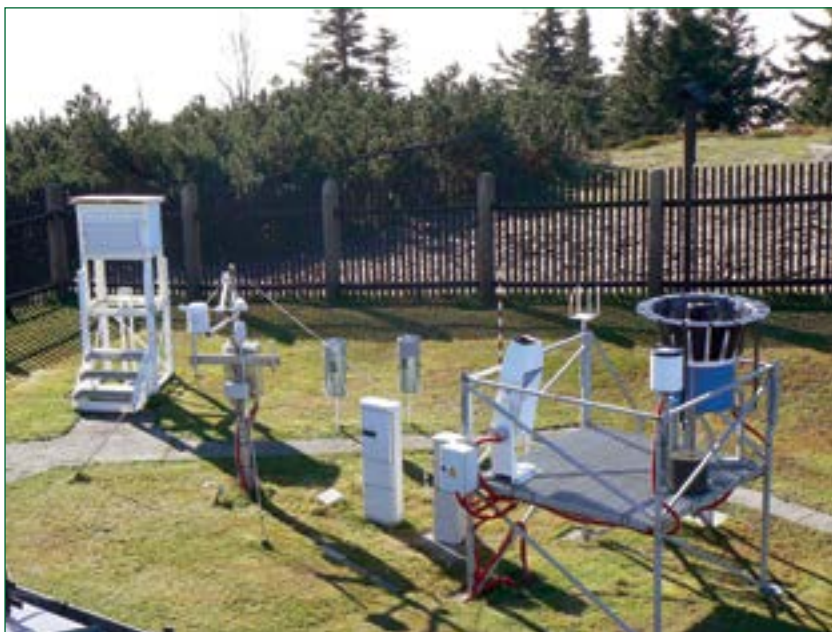
Obr. 4 Meteozahrádka z října 2012 s kovovou rampou pro ceilometr, člunkový a váhový srážkoměr. Foto archiv ČHMÚ.
