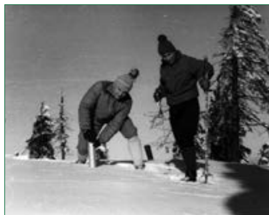
Obr. 5 Měření vodní hodnoty celkové sněhové pokrývky na Lysé hoře váhovým sněhoměrem Metra. Foto N. Slabá.
