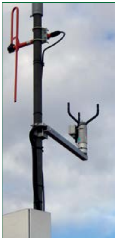
Obr. 3 Původní anemometr VAISALA WS425 s přidavným vyhříváním. Foto Vladimír Vozobule.
